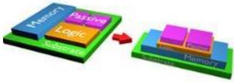
Figure 1 : Illustration de l'assemblage 3D des puces électroniques
